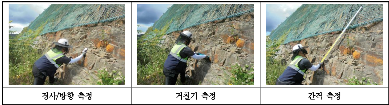
【사진 30.3.2】 불연속면 측정 현황
